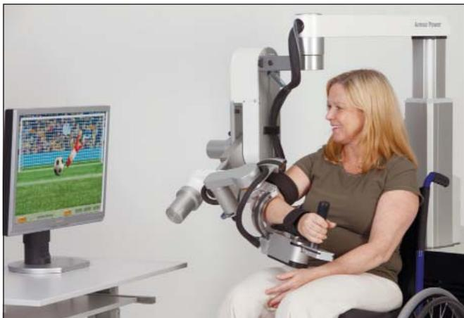
Рис. 1. Роботизированный комплекс Armeo Power, Носота (Швейцария) с биологической обратной связью
