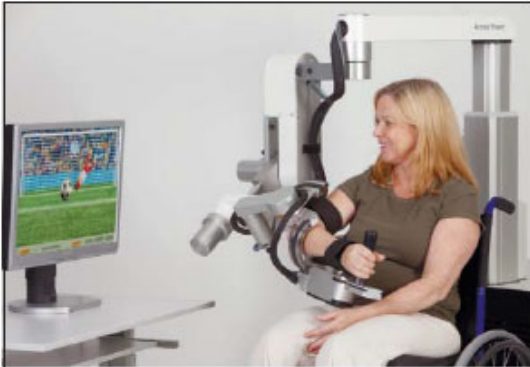
Рис. 1. Роботизированный комплекс Argeo Power, Носота (Швейцария) с биологической обратной связью
